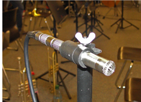
Bild 2: Messmikrofon mit Anschluss an CESVA
